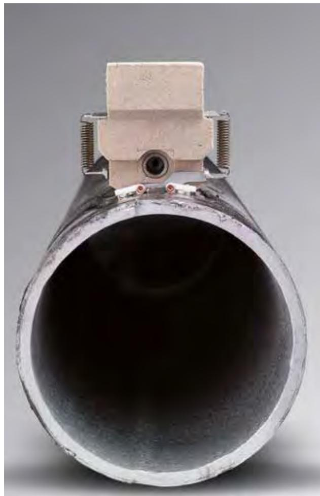
Contrairement à d'autres procédures de soudage, la procédure de tube de soudure **ELPA-KLK** n'affecte pas l'acier de tube. Une étude micrographique de l'union par soudage capillaire entre plaque et tube révèle que la structure de l'acier du tube reste inchangée et sans microfissures.
