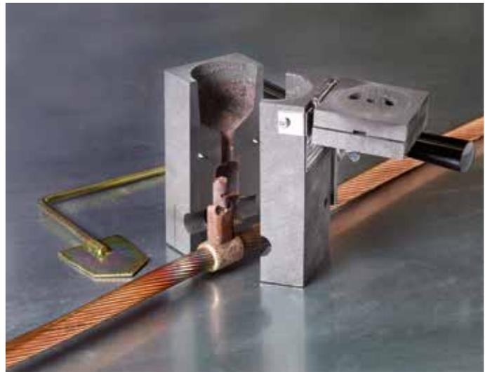
Les connexions qui sont réalisées en appliquant les procédures de soudage KLK, et en particulier celles qui sont réalisées après l'application de la procédure d'allumage LsVIP, sont des connexions avec une excellente conductivité électrique, égale ou supérieure à celle des conducteurs connectés.
