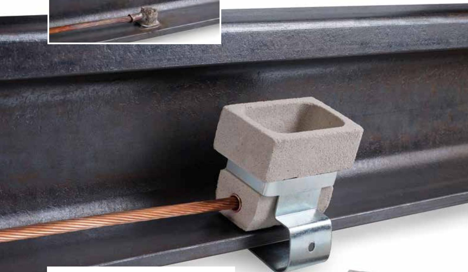
Le procédé de soudure **ELPA KLK-weld** offre la meilleure solution pour la soudure de câbles en cuivre au patin du rail. Le résultat est une connexion avec une résistivité électrique très basse et une haute résistance mécanique sans pour autant modifier l'acier du rail du fait que sa température ne dépasse jamais les 600°C.
