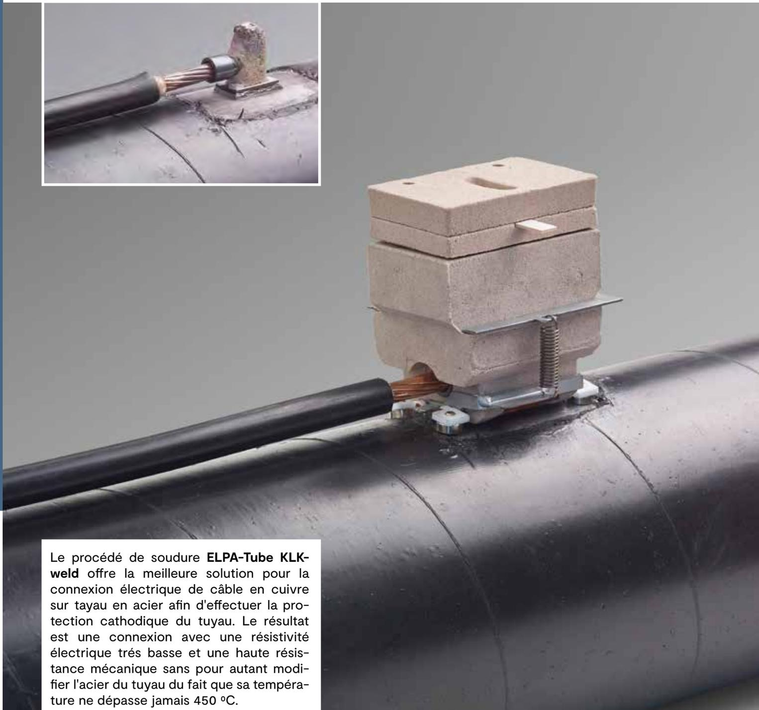
Le procédé de soudure **ELPA-Tube KLK-weld** offre la meilleure solution pour la connexion électrique de câble en cuivre sur tuyau en acier afin d'effectuer la protection cathodique du tuyau. Le résultat est une connexion avec une résistivité électrique très basse et une haute résistance mécanique sans pour autant modifier l'acier du tuyau du fait que sa température ne dépasse jamais 450 °C.
