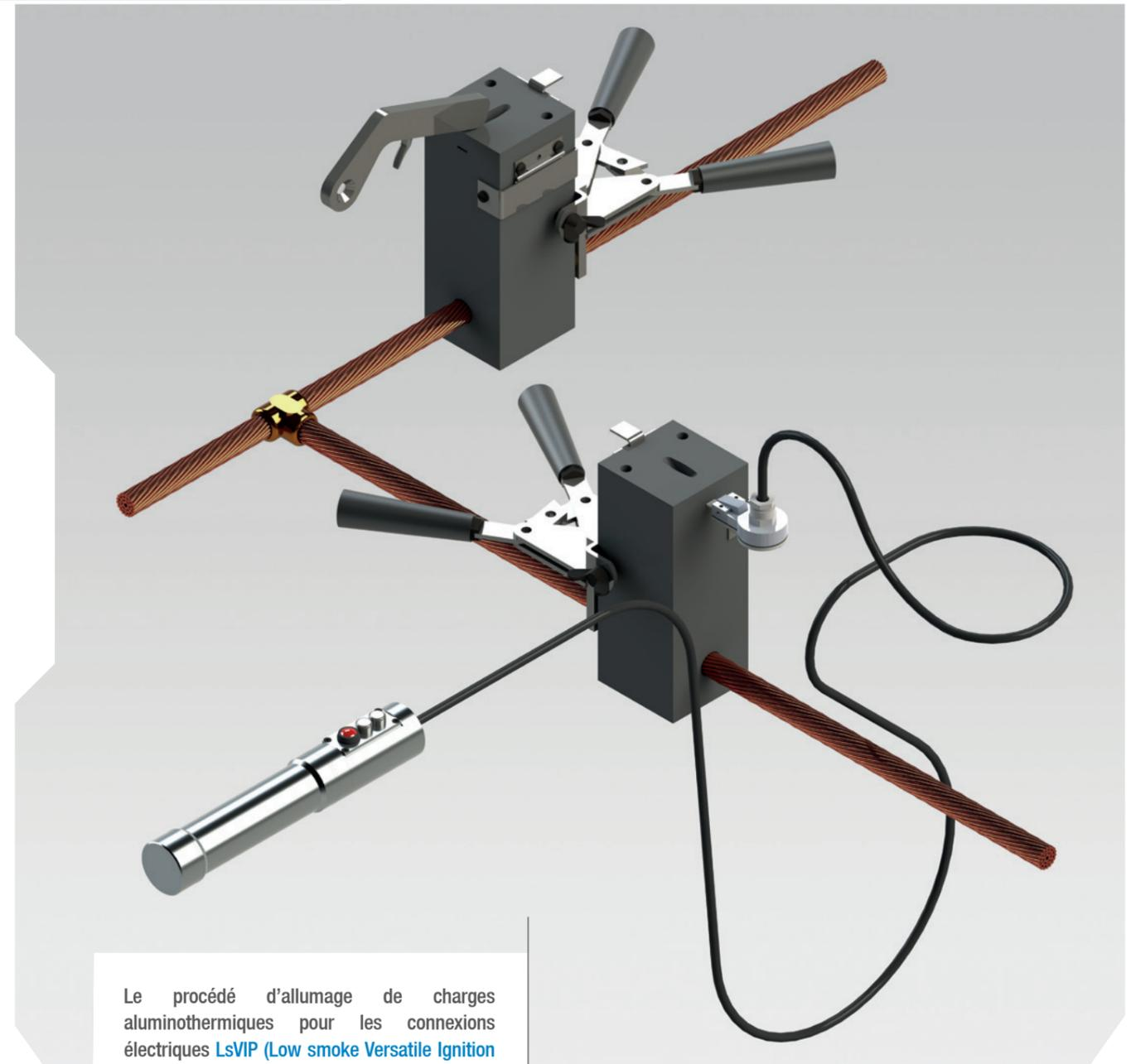
Le procédé d'allumage de charges aluminothermiques pour les connexions électriques LsVIP (Low smoke Versatile Ignition Procedure) offre la meilleure solution pour l'allumage en termes de sécurité et de propreté. Il évite l'échappement de projections produites pendant la réaction aluminothermique dans le creuset du moule, il réduit les émissions de fumée et il permet de maintenir une distance de sécurité pendant l'allumage s'il est utilisé avec le Dispositif d'Allumage à Distance KLK-weld.
