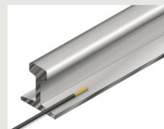
1. Quitar el aislamiento del cable unos 15 cm. Limpiar la superficie a soldar con la carda para eliminar óxidos e impurezas.
