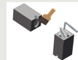
9. Eliminar la escoria de la tolva, el orificio de colada y la tapa del molde con un rascador de moldes. Limpiar los restos de suciedad de la cámara de soldadura con una brocha.
