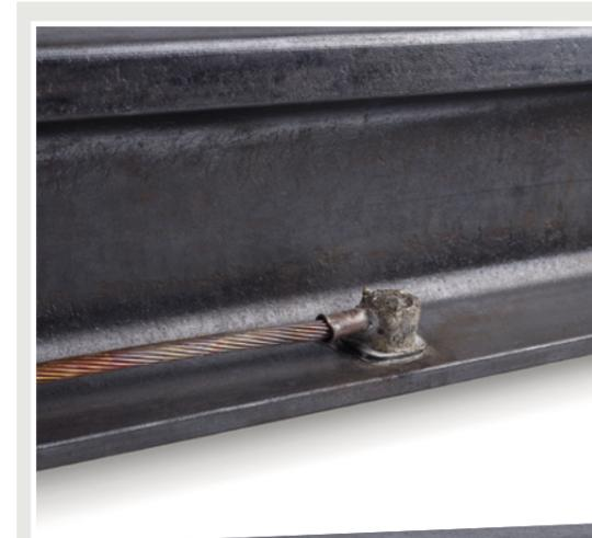
El procedimiento de soldadura **ELPA KLK-weld** es la mejor solución para realizar conexión eléctrica de cable de cobre al patín del carril, pues se consigue una baja resistividad eléctrica y una alta resistencia mecánica en la conexión, todo ello sin afectar al acero del carril, pues la temperatura en el mismo nunca supera los 600°C.
