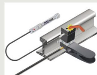
7. Cerrar la tapa del molde. Colocar la pistola lateralmente sobre el polvo de ignición o el dispositivo de encendido a distancia y accionarlos para conseguir el encendido.
