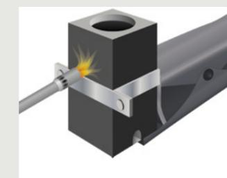
3. Antes de la primera soldadura precalentar el molde durante al menos 5 minutos para eliminar la humedad y evitar poros en la soldadura.
