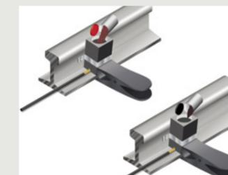
6. Abrir la tapa de color del cartucho y vaciar el polvo de soldadura en la tolva del molde.
