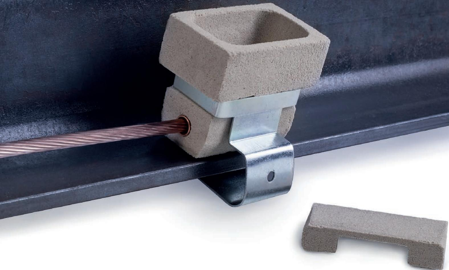
La **PROCÉDURE DE SOUDAGE ELPA KLK** est la meilleure solution pour réaliser la connexion électrique du câble en cuivre au rail, car elle permet d'obtenir une faible résistivité électrique et une forte résistance mécanique dans la connexion sans affecter l'acier du rail, car sa température ne dépasse jamais 600 °C.
