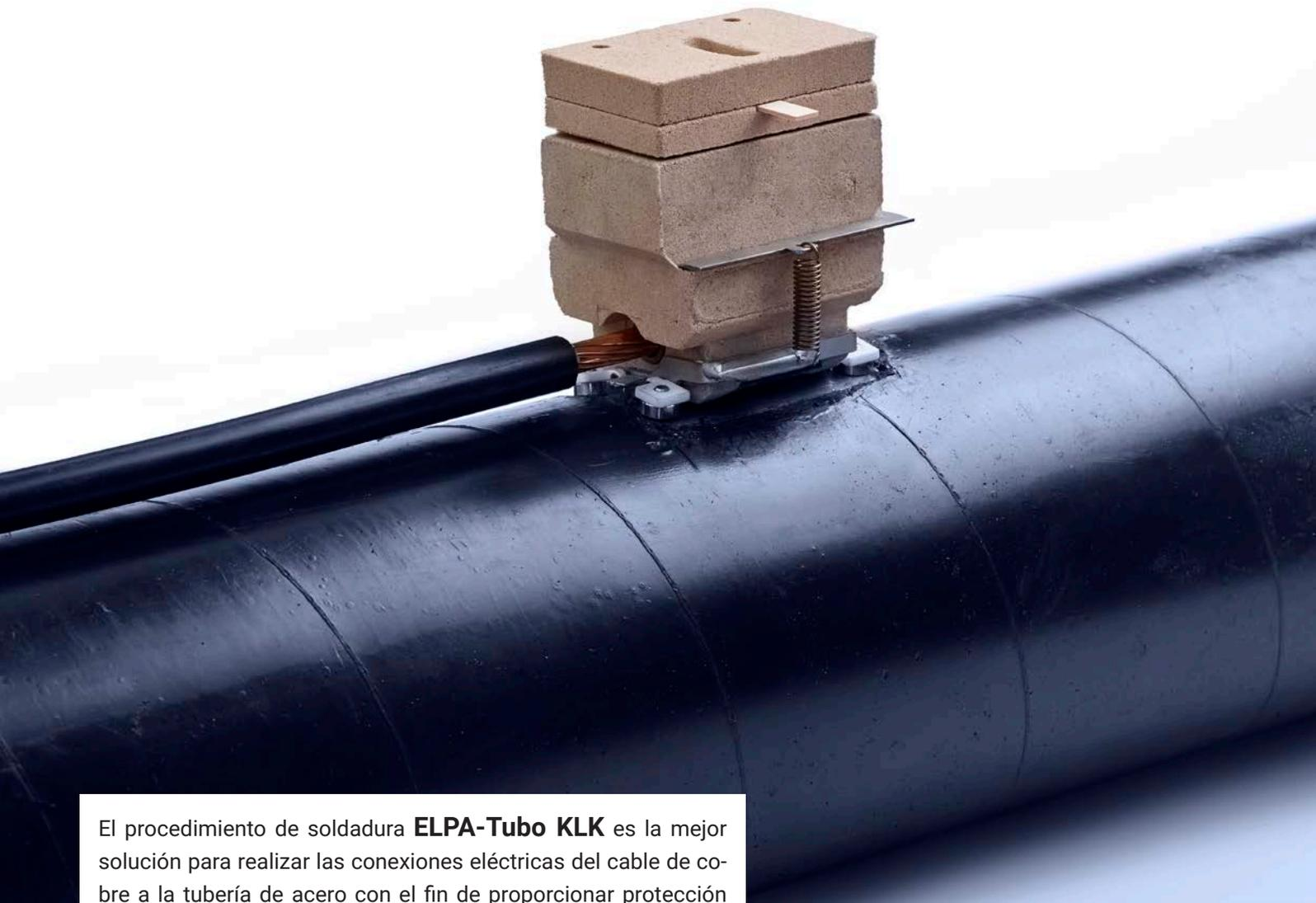
El procedimiento de soldadura **ELPA-Tubo KLK** es la mejor solución para realizar las conexiones eléctricas del cable de cobre a la tubería de acero con el fin de proporcionar protección catódica a la tubería, ya que la soldadura resultante tiene una baja resistividad eléctrica y una alta resistencia mecánica en la conexión. **Este procedimiento no altera la estructura de la tubería de acero**, ya que la temperatura nunca supera los 450°C.
