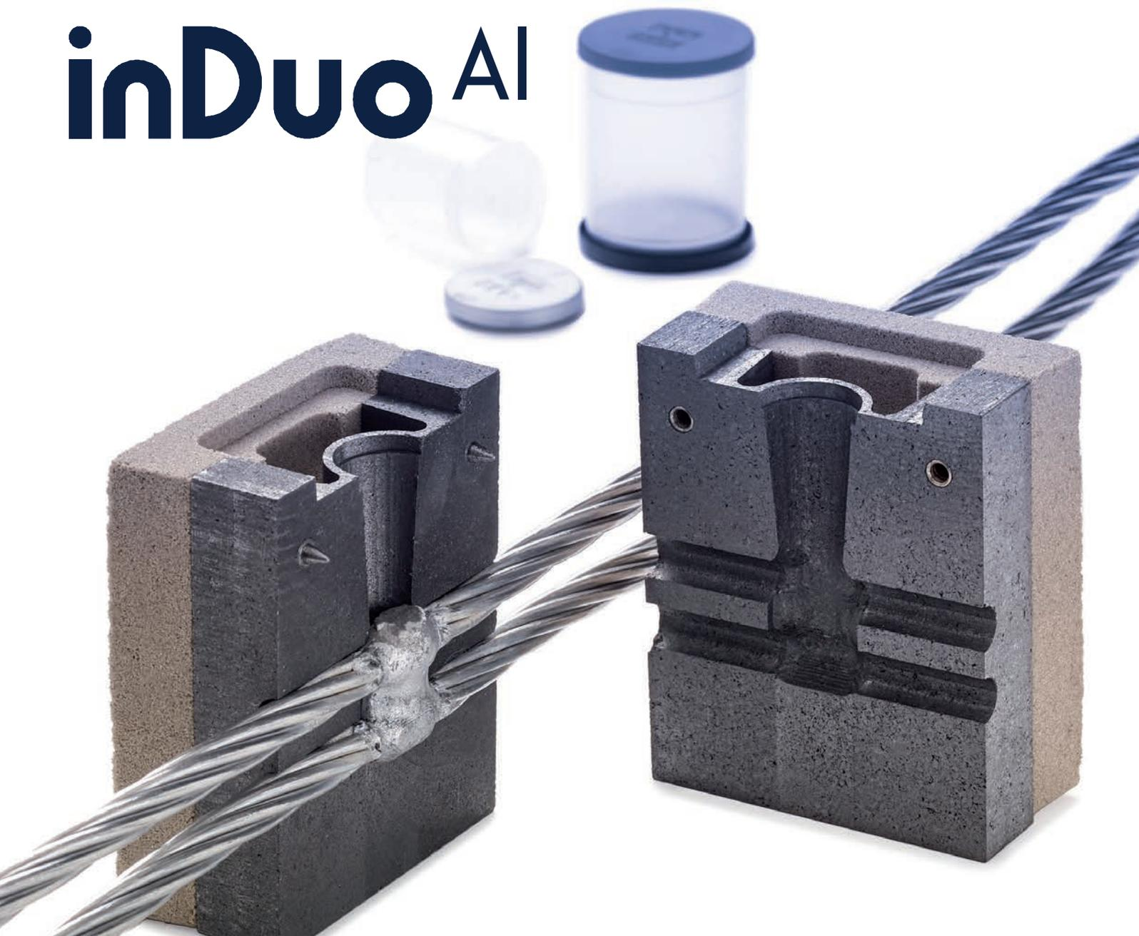
El **procedimiento de soldadura KLK-weld inDuo<sup>Al</sup>**, utiliza una mezcla exotérmica como fuente de calor, es la mejor solución de soldadura cuando uno de los componentes a soldar es aluminio, ya que el metal de aportación es del mismo tipo, es decir, también aluminio o una aleación de aluminio.
