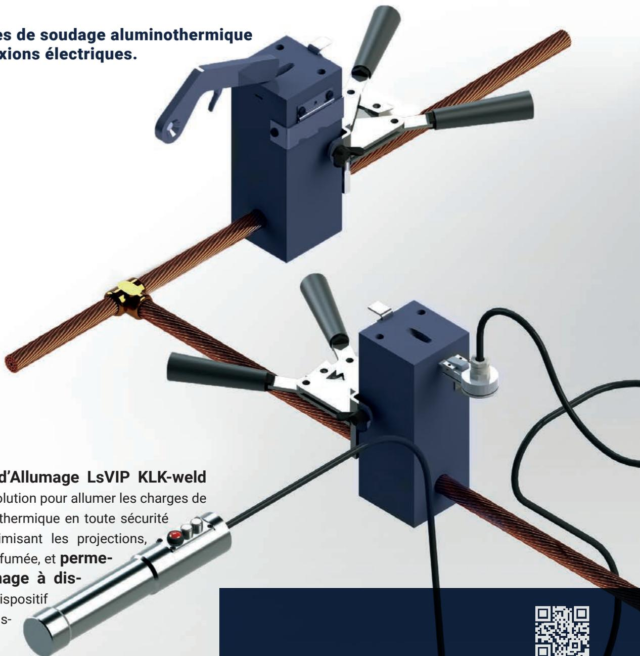
La **Procédure d'Allumage LsVIP KLK-weld** est la meilleure solution pour allumer les charges de soudage aluminothermique en toute sécurité et propreté, minimisant les projections, les émissions de fumée, et **permettant un allumage à distance** avec le Dispositif d'Allumage à Distance KLK-weld.
