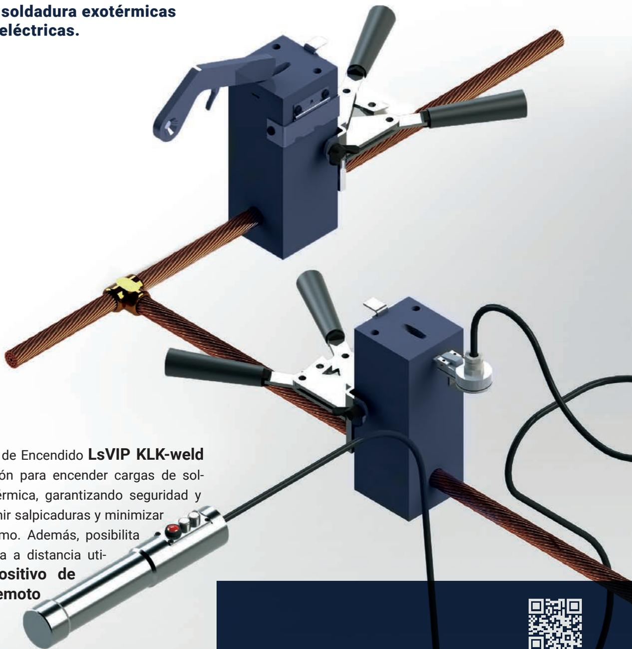
El Procedimiento de Encendido **LsVIP KLK-weld** es la mejor opción para encender cargas de soldadura aluminotérmica, garantizando seguridad y limpieza al prevenir salpicaduras y minimizar emisiones de humo. Además, posibilita encender la carga a distancia utilizando el **Dispositivo de Encendido Remoto KLK-weld**.
