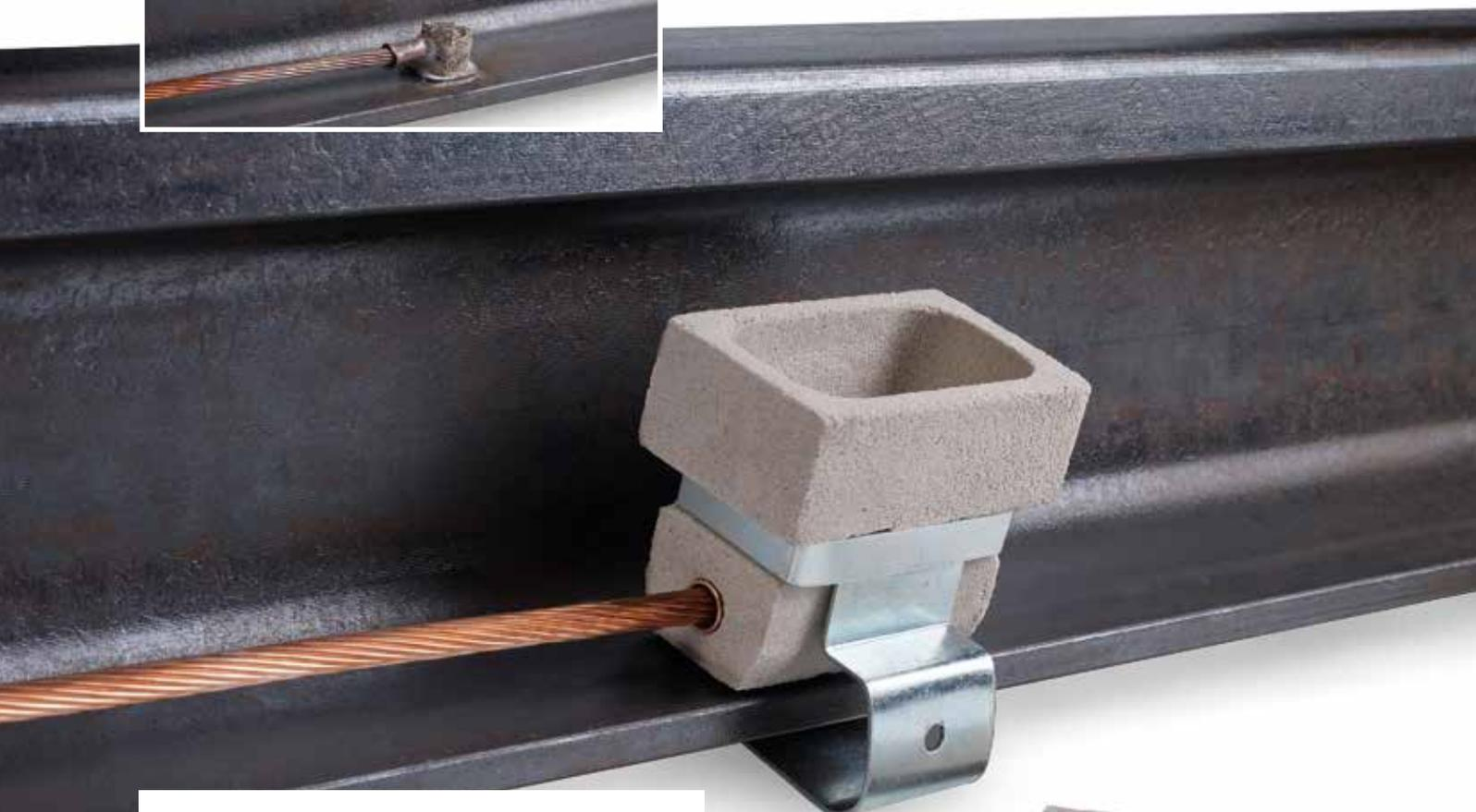
El procedimiento de soldadura **ELPA KLK-weld** es la mejor solución para realizar conexión eléctrica de cable de cobre al patín del carril, pues se consigue una baja resistividad eléctrica y una alta resistencia mecánica en la conexión, todo ello sin afectar al acero del carril, pues la temperatura en el mismo nunca supera los 600°C.
