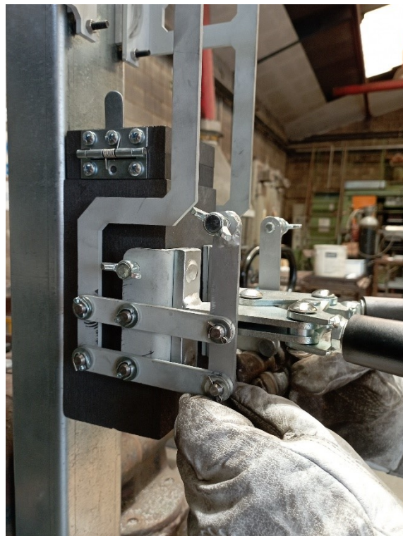
PASO 4: Accionar el mecanismo para que tanto los imanes como el molde queden paralelos y coincidentes con la superficie del perfil
