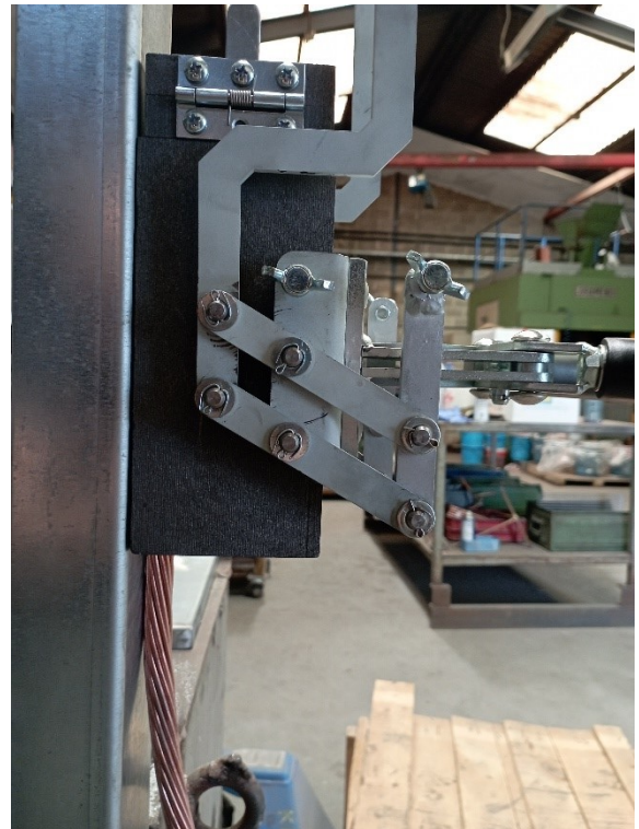
PASO 6: Asegurarse de que la presencia del cable no provoca la separación del molde con respecto al perfil. Para ello, puede ser necesario enderezarlo manualmente
