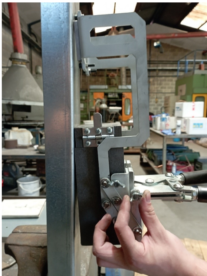
PASO 3: Aflojar los dos tornillos de mariposa para liberar la posición del mecanismo
