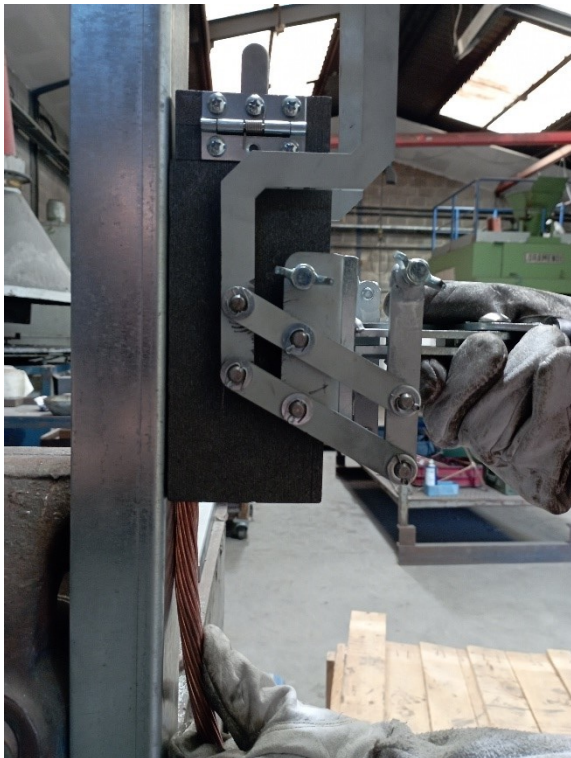
PASO 6: Asegurarse de que la presencia del cable no provoca la separación del molde con respecto al perfil. Para ello, puede ser necesario enderezarlo manualmente
