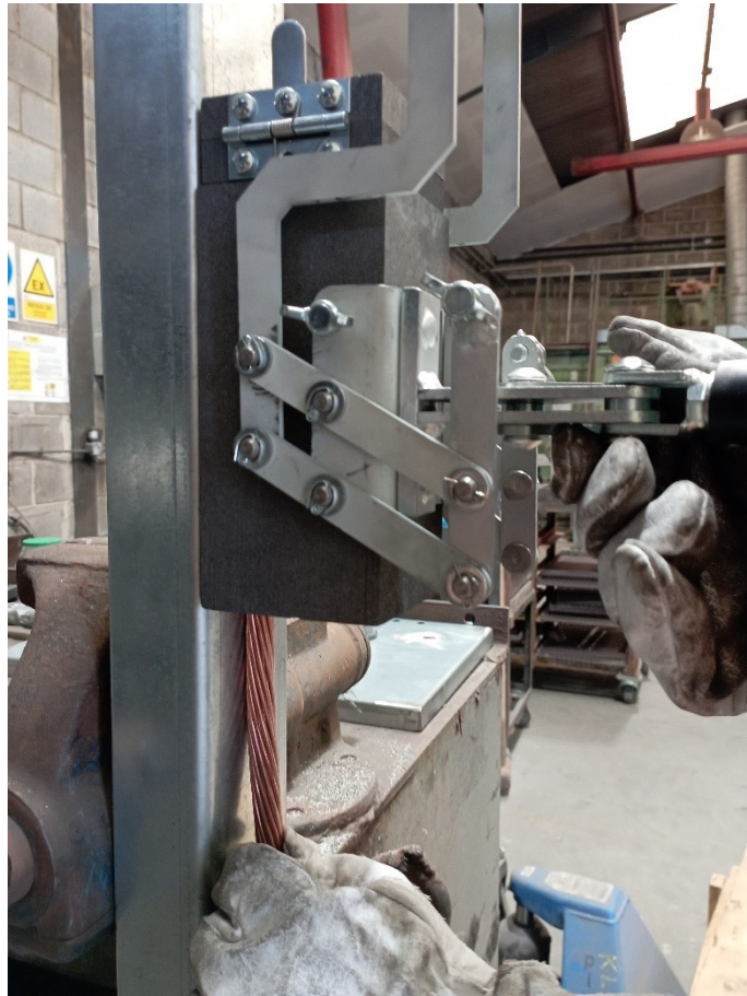
PASO 5: Introducir el cable en el molde
