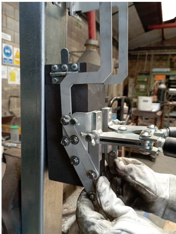
PASO 4: Accionar el mecanismo para que tanto los imanes como el molde queden paralelos y coincidentes con la superficie del perfil
