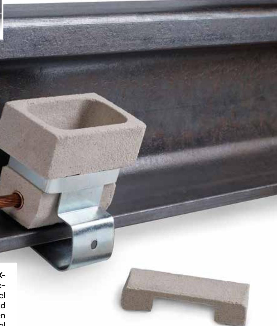
El procedimiento de soldadura **ELPA KLK-weld** es la mejor solución para realizar conexión eléctrica de cable de cobre al patín del carril, pues se consigue una baja resistividad eléctrica y una alta resistencia mecánica en la conexión, todo ello sin afectar al acero del carril, pues la temperatura en el mismo nunca supera los 600°C.
