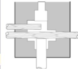
**1. Soldadura aluminotérmica del cobre /**
