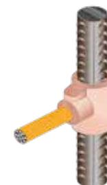
**1. Soldadura aluminotérmica del cobre /**
