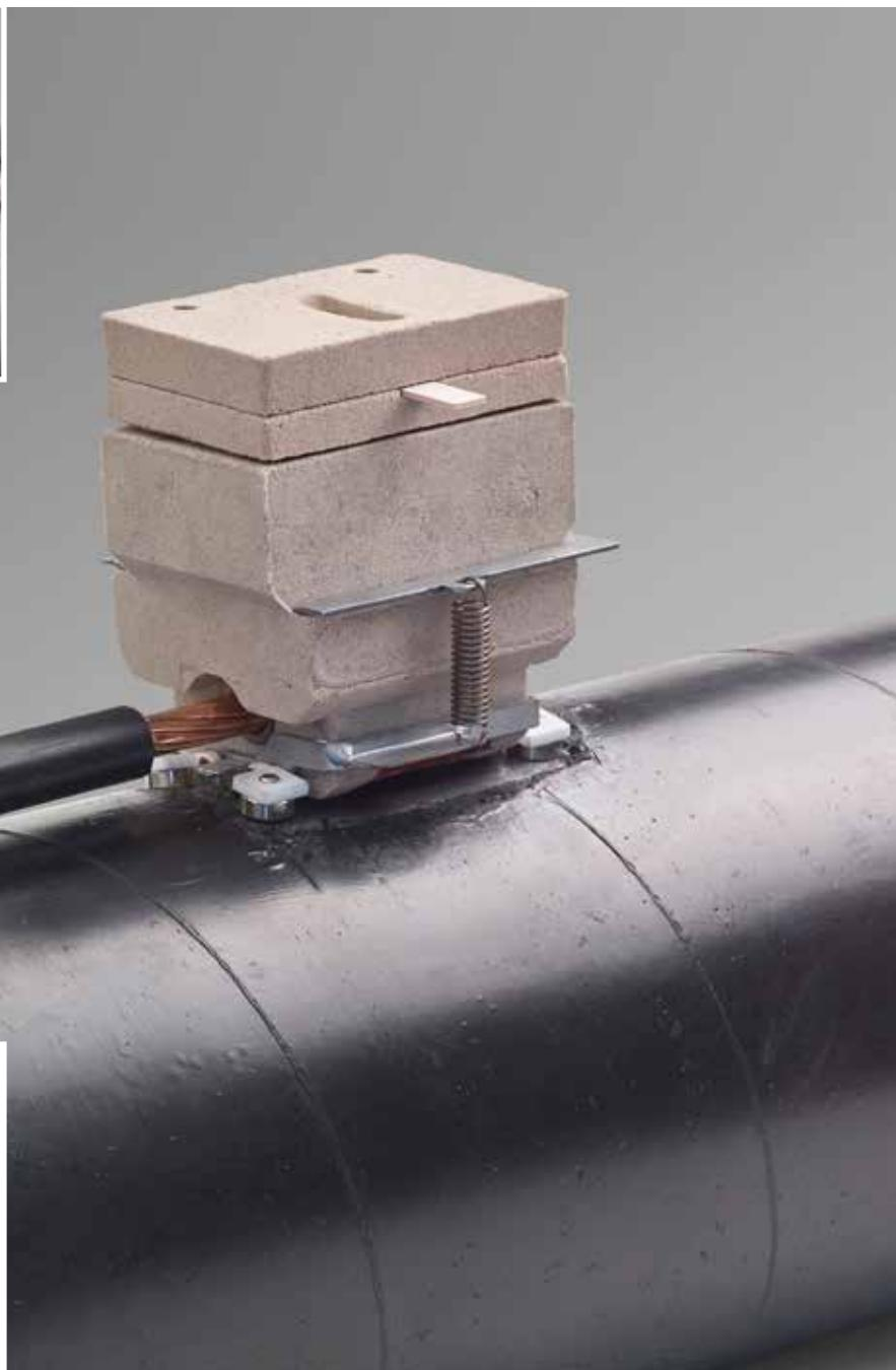
El Procedimiento de soldadura **ELPA-Tubo** **KLK-weld** es el mejor procedimiento para realizar conexión eléctrica de cable de cobre a tubo de acero, con el fin de realizar protección catódica de ese tubo, pues se consigue una baja resistividad eléctrica y una alta resistencia mecánica en la conexión, todo ello sin afectar al acero del tubo, pues la temperatura en el mismo no supera los 450°C.
