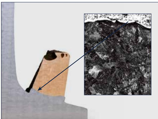
A diferencia de otros procedimientos de soldadura, el procedimiento **ELPA KLK-weld** no afecta al acero del carril. Un estudio micrográfico de la unión mediante soldadura capilar entre placa y carril revela que la estructura del acero del carril se mantiene inalterada, totalmente perlítica, y sin microgrietas.
