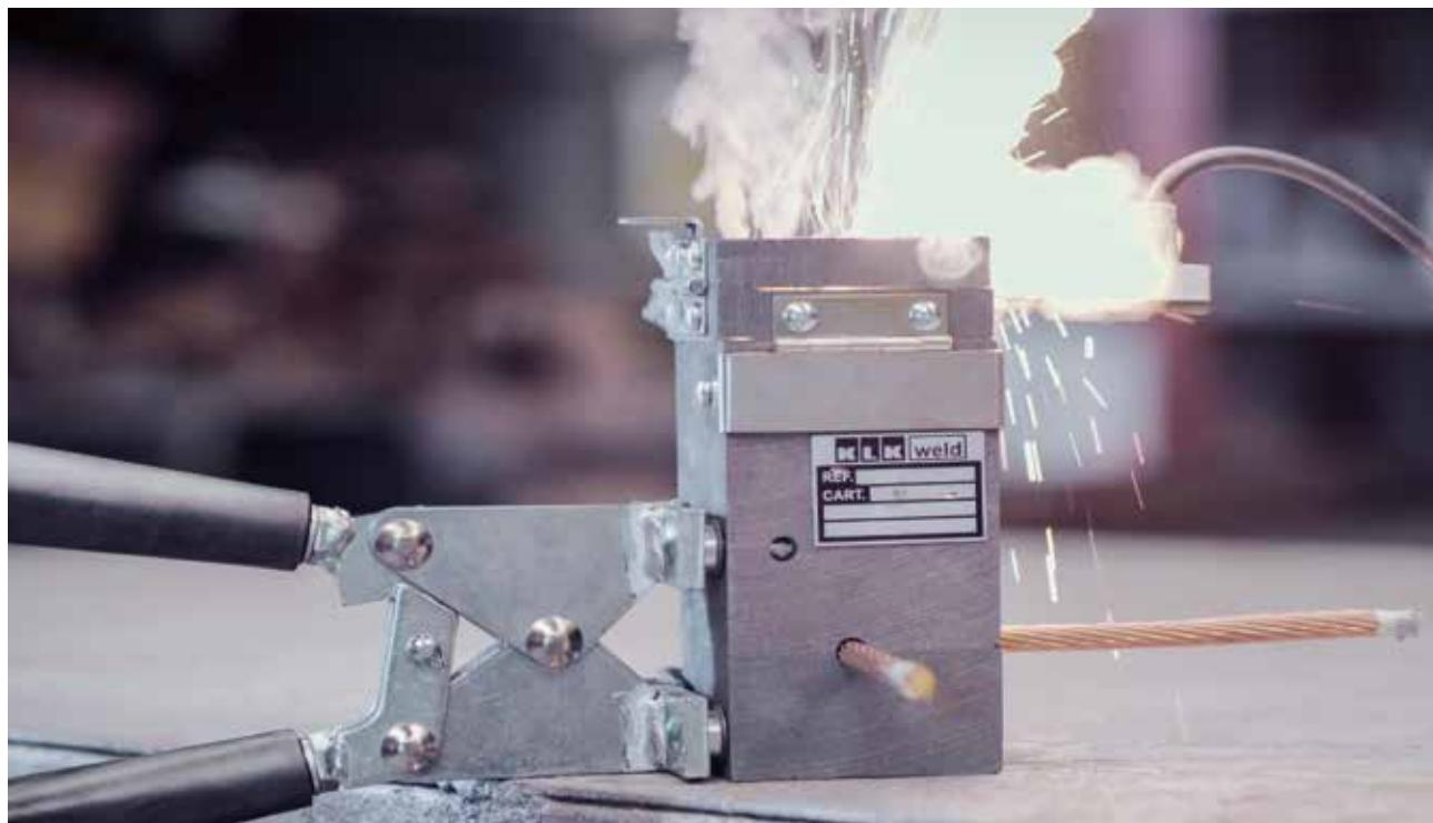
1. Soldadura aluminotérmica del cobre /
