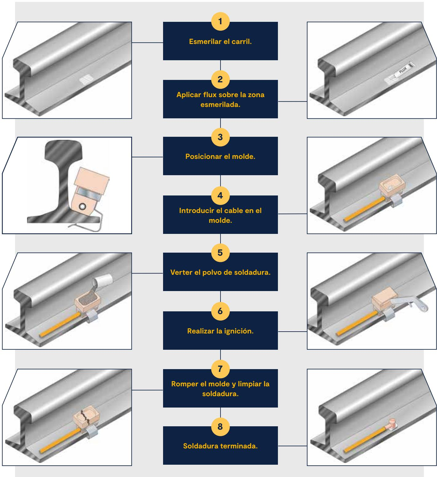
**1. Soldadura aluminotérmica del cobre /**
