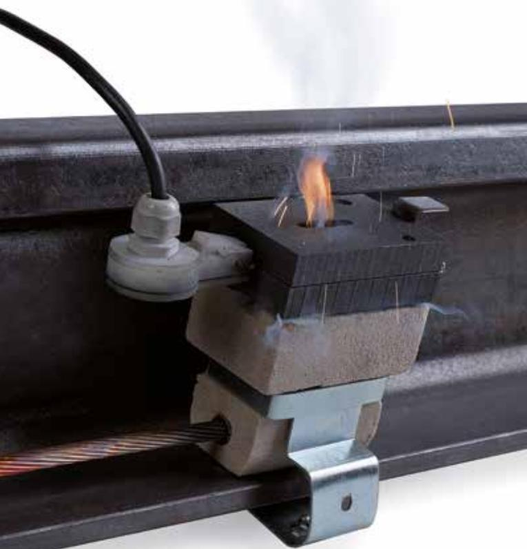
La resistencia eléctrica de la conexión es menor que  $10^{-5} \Omega$ , y la resistencia mecánica a la cizalladura en la unión placa/carril es mayor que 50 kN.
