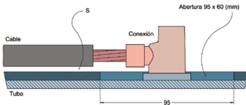
La zona a proteger incluye la abertura practicada en el aislamiento del tubo, de dimensiones 95 x 60 (mm), el extremo del cable cuyo aislamiento se había retirado en una longitud de 50 mm, y la propia conexión. El espacio existente entre aislamientos de cable y tubo (S) favorece el flujo de la resina de recubrimiento en esa zona.
