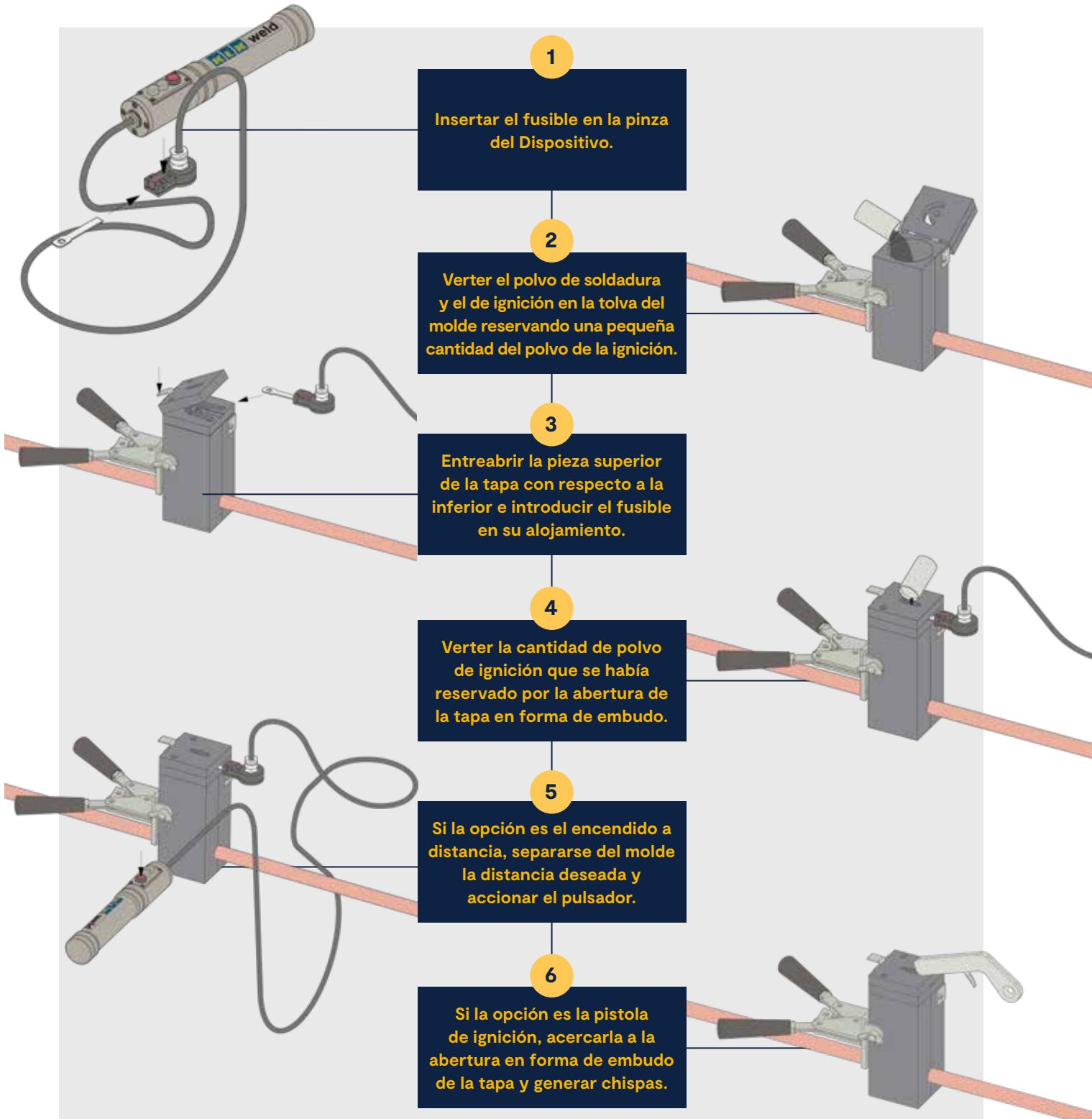
**1. Soldadura aluminotérmica del cobre /**
