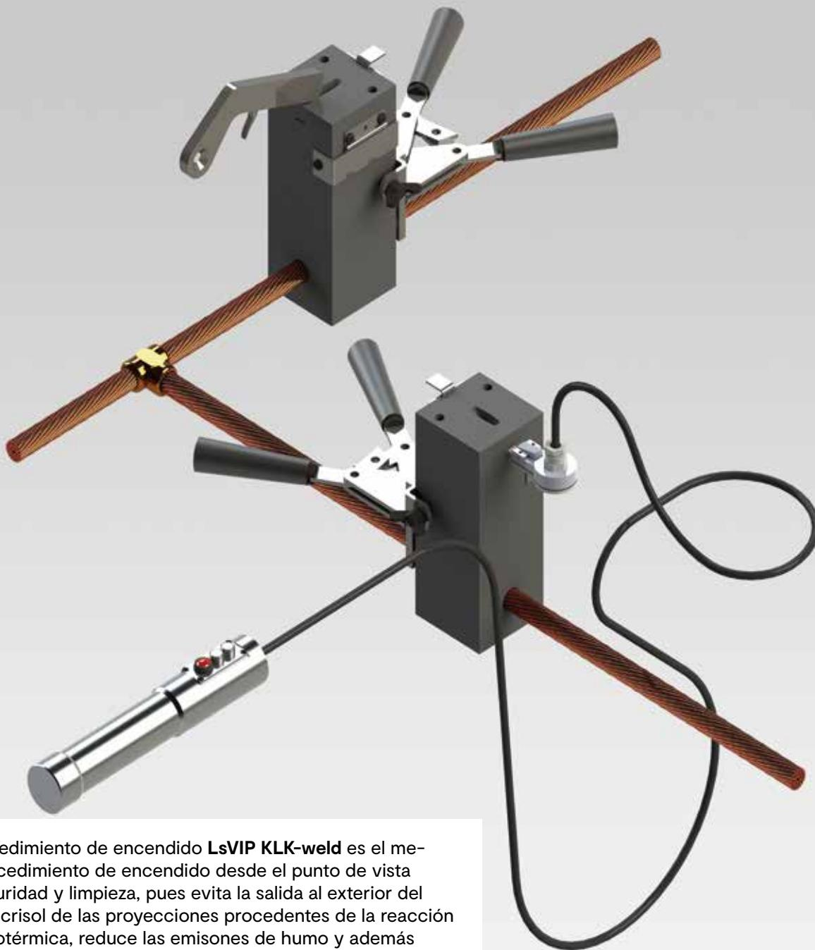
El procedimiento de encendido **LsVIP KLK-weld** es el mejor procedimiento de encendido desde el punto de vista de seguridad y limpieza, pues evita la salida al exterior del molde-crisol de las proyecciones procedentes de la reacción aluminotérmica, reduce las emisiones de humo y además posibilita la realización del encendido a cierta distancia del molde, utilizando para ello el **Dispositivo de Encendido a Distancia KLK-weld**.
