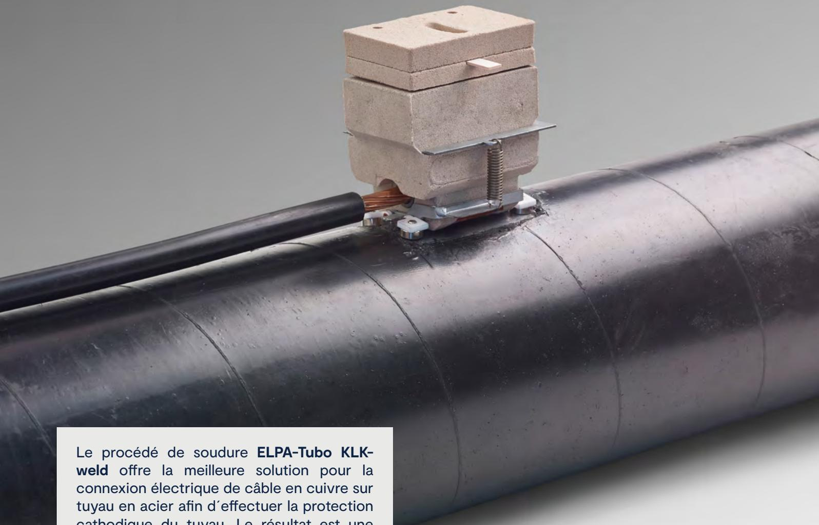
Le procédé de soudure **ELPA-Tubo** **KLK-weld** offre la meilleure solution pour la connexion électrique de câble en cuivre sur tuyau en acier afin d'effectuer la protection cathodique du tuyau. Le résultat est une connexion avec une résistivité électrique très basse et une haute résistance mécanique sans pour autant modifier l'acier du tuyau du fait que sa température ne dépasse jamais les 450 °C.
