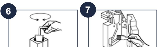
**7.** Eliminar los restos de la cavidad de soldadura por medio de la brocha. // Retirer les restes de la cavité de soudage en utilisant la brosse. // Remove the remains from the welding cavity using the brush.
