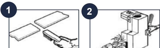
**2.** Antes de la primera soldadura, precalentar el molde durante 5 min. // Avant la première soudure, préchauffer le moule pendant 5 min. // Before the first welding, preheat the mould for 5 min.
